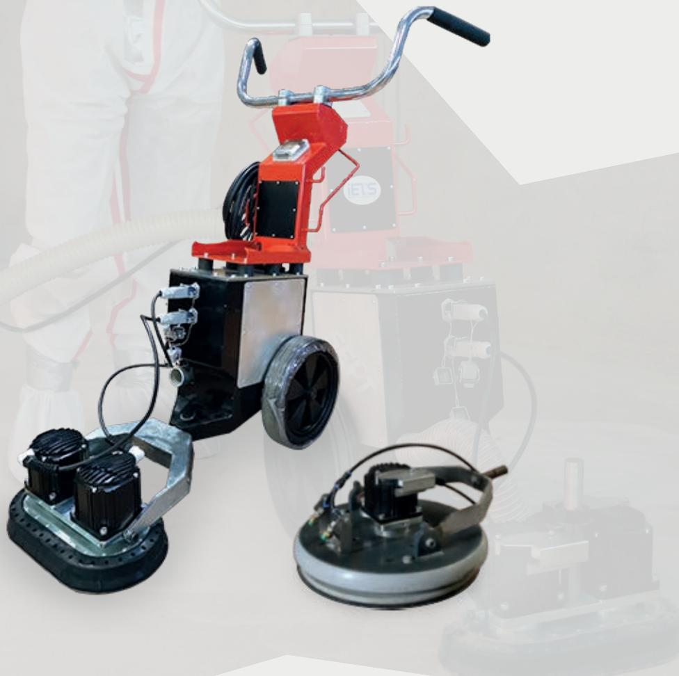
Le **TAPIR XTT330** a été développé avec nos moteurs brushless (sans bruit, sans vibrations, longévité accrue et waterproof) pour de la rénovation, construction, démolition, désamiantage et démantèlement.
